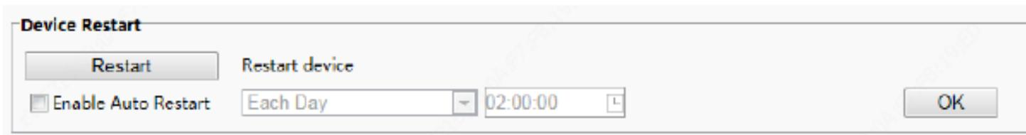
(2) Em Reiniciar dispositivo, clique em Reiniciar. O dispositivo irá reiniciar após você confirmar a operação.
