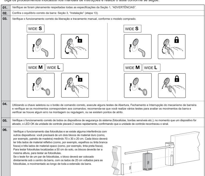
Se o teste for com dois pares de fotocélulas, o teste deverá ser realizado primeiro individualmente com cada par de fotocélulas, utilizando-se um bloco de teste e depois 2 blocos.
